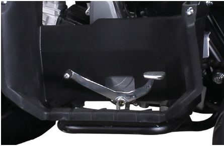
Fußablage mit Gangschaltung (links)
