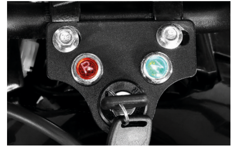
Kontrollleuchte für Neutralstellung (N)
