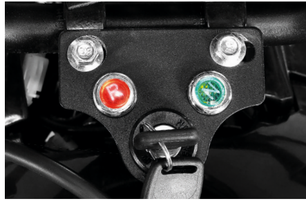
Kontrollleuchte für Rückwärtsgang (R)
