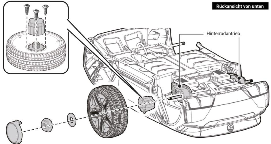
Tipp: Es wurde ein zusätzlicher Schraubenschlüssel bereitgestellt, um die Sicherungsmutter auf der anderen Seite der Hinterachse zu halten, während Sie die Sicherungsmutter auf der anderen Seite anziehen. Bringen Sie die Nabenkappen an den Rädern an.
