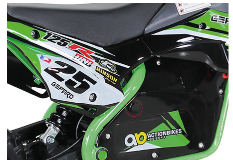
Der Ladeanschluss befindet sich an der rechten Batterieabdeckung.
