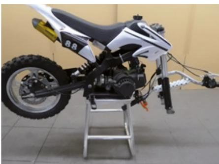
Stellen Sie das Crossbike auf einen Montageständer/eine Erhöhung, um den Zusammenbau zu erleichtern.
